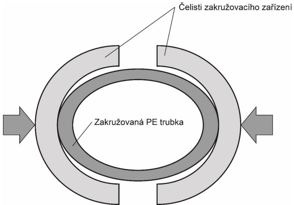
Obrázek 8 – Schematické znázornění funkce zakružovacího zařízení
