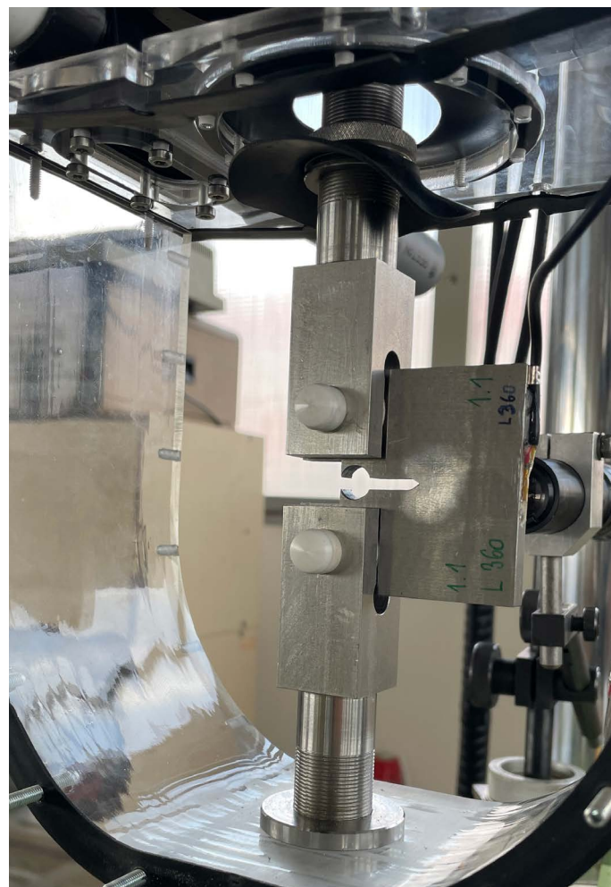
Obr. 5 – Fotografie z měření referenčního vzorku, kde bylo provedeno optické měření délky trhliny pomocí Brinellovy lupy (v zadní části fotografie) a měření pomocí tenzometru, umístěného na protilehlé straně vzorku proti straně s trhlinou
