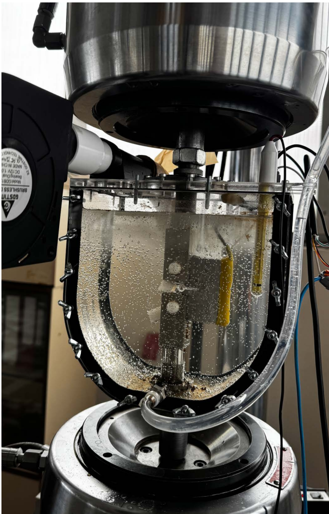
Obr. 6 – Sestava pro elektrolytické sycení vzorku vodíkem při jeho cyklickém zatěžování
