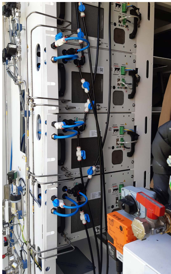
Modulární elektrolyzátor 10,6 kW
